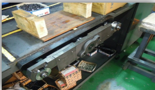
ツールチェンジアーム 精度測定
